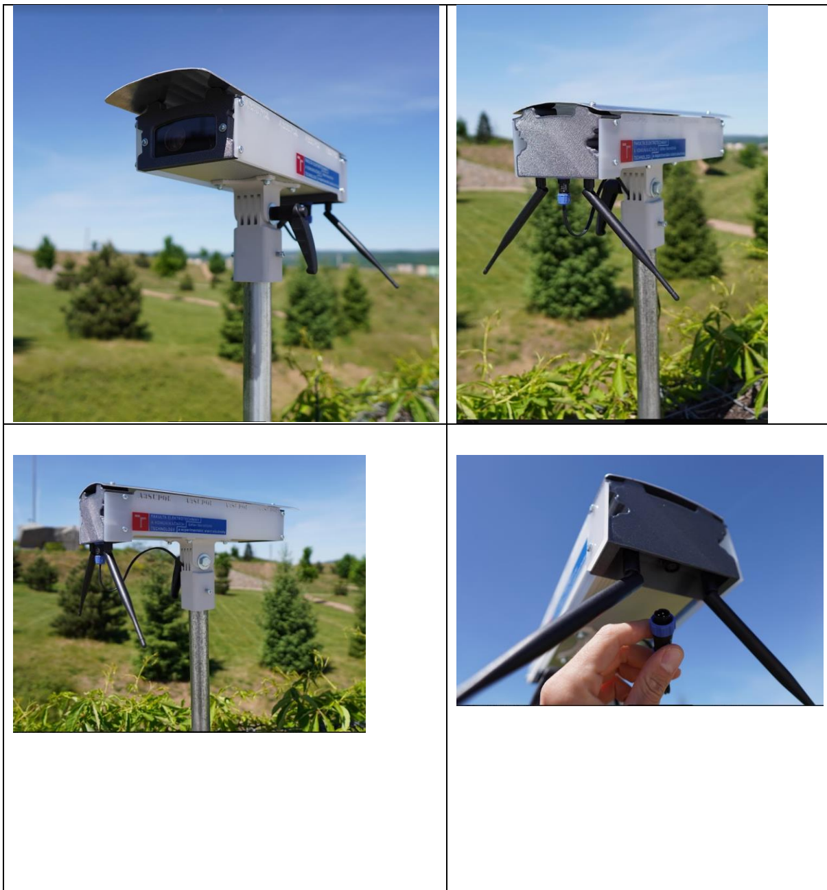
Obr. 2: Finální verze funkčního vzorku pasivního optického detektoru.
