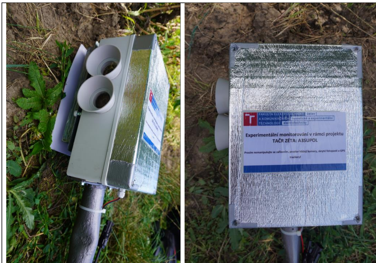
Obr. 4: Finální verze optického detektoru pohybujících se objektů včetně stínění.
