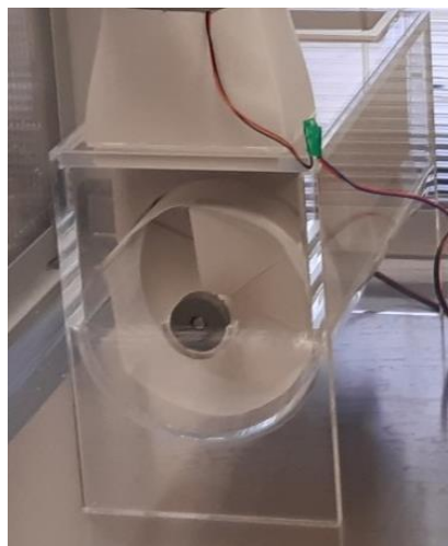
Obr. 1: Šneková rotační jednotka pro záchyt virových patogenů.
