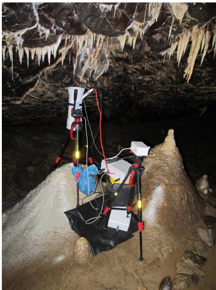
Obr. 2: Umístění jeskynního kapkometru s dataloggerem u „Záclon“ v Amatérské jeskyni.
