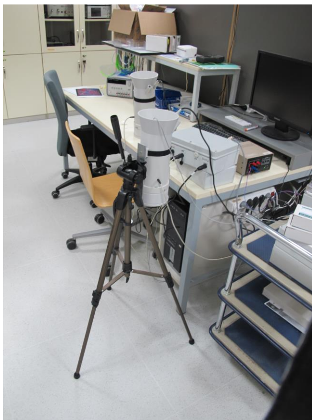
Obr. 1: Kalibrace jeskynního kapkometru s dataloggerem v laboratoři.
